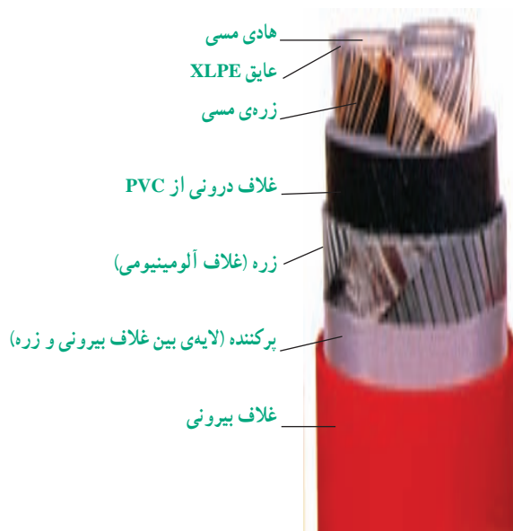
شکل ۲-۶- کابل با غلاف آلومینیومی
