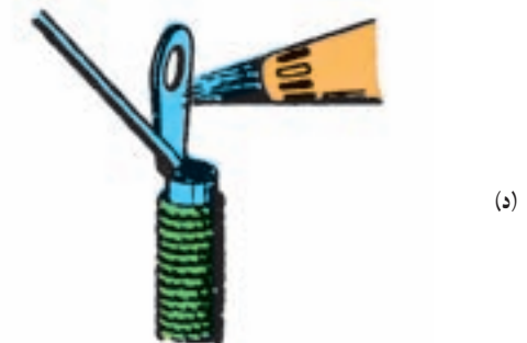
شکل ۲۲-۲- مراحل لحیم کاری کابل شو
