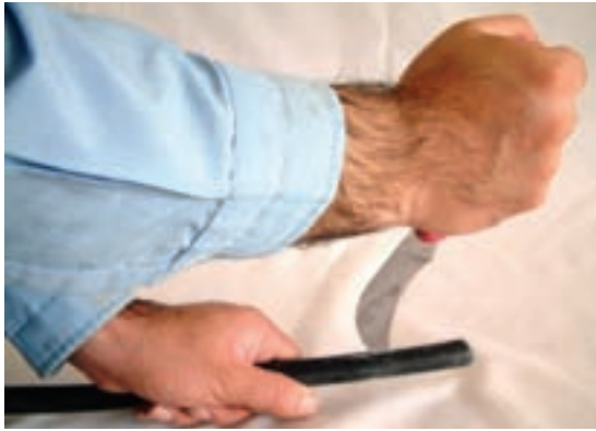
شکل ۲۵-۲- طریقه‌ی صحیح روکش برداری کابل
