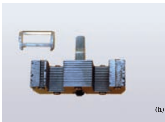
شکل ۳-۴- مراحل باز کردن اجزای تشکیل دهنده‌ی کنتاکتور
